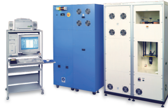
パルス磁化測定装置 (TPM型)
